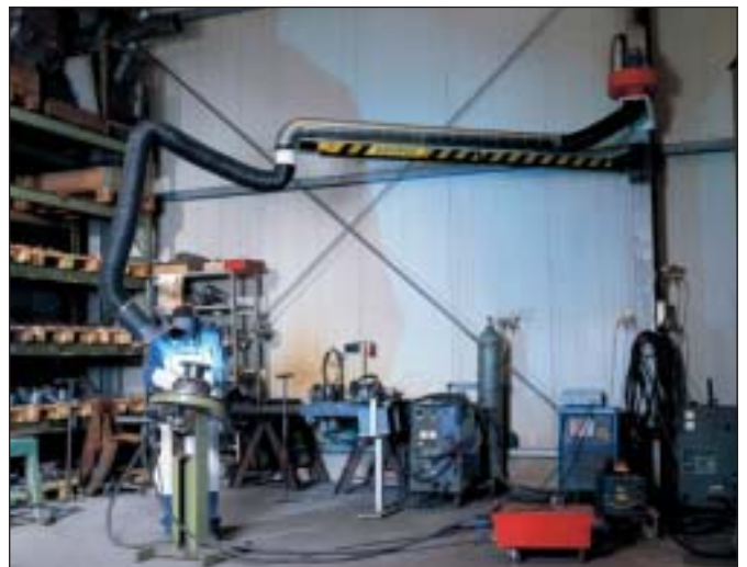
Figuur 3. Intelligente sensoren kunnen, bijvoorbeeld bij de lasrookproblematiek, de ventilatielucht sturen op basis van de werkelijke waarde.
